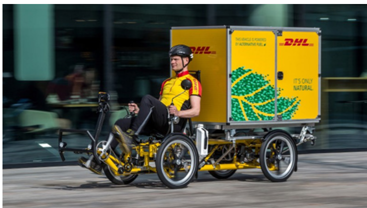
O cubiciclo transporta um contêiner de um metro cúbico com uma carga de até 125 kg de cartas
