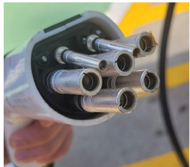
Figura 25. Imagem de conector danificado
